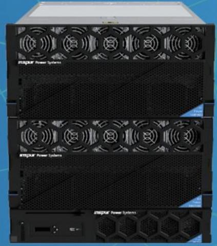
浪潮K1 Power K8870G3最多可支持8颗Power10处理器，80个Power10处理器核心，主频高达3.90GHz，整机最大支持32TB高速企业级内存，系统可靠性超过99.999%，面向关键应用整合，保证客户核心业务系统稳定运行。
